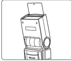
Wenn Sie die Kamera für Hochformataufnahmen seitlich gekippt und den Reflektor dann durch geeignetes Schwenken nach oben gerichtet haben, würde die weiße Plastikscheibe in die falsche Richtung zeigen, um den beschriebenen Aufhellereffekt zu erzeugen. Sie können dann, aber ebenso bei normalen Querformataufnahmen, den **Zweitreflektor** (siehe Seite 15) des Di866 Mark II zur frontalen Aufhellung zuschalten. Dabei haben Sie sogar die Möglichkeit, unter 8 verschiedenen Helligkeitsstufen zu wählen.
