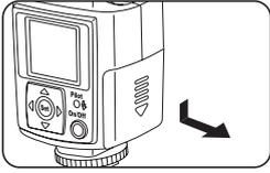
1. Nehmen Sie das Batteriemagazin wie in den Bildern links gezeigt heraus und legen Sie vier Batteriezellen des Typs Mignon ein (andere Bezeichnungen für diesen Typ sind LR6, HR6 oder AA).
