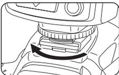
5. Dabei wird der Arretierstift im Fuß des Di866 Mark II ausgefahren, um das Blitzgerät im Aufsteckschuh vor versehentlichem Herausrutschen zu sichern.
