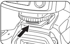
3. Stecken Sie den Di866 Mark II (mit nach vorn gerichtetem Reflektorfenster) in den Aufsteckschuh der Kamera.
